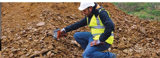
Permet de déterminer la composition élémentaire des principaux constituants dont le numéro atomique est supérieur à celui de l'Aluminium en quelques minutes.
