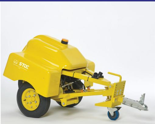
APPAREIL DE MESURE DE FROTTEMENT
