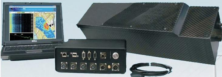
L'IMAGERIE ÉLECTROMAGNÉTIQUE DES VARIATIONS DE CONDUCTIVITÉ ÉLECTRIQUE DU SOUS-SOL, DEPUIS LA SURFACE JUSQU'À QUELQUES DIZAINES À CENTAINES DE MÈTRES DE PROFONDEUR, SELON LE MATÉRIEL UTILISÉ
