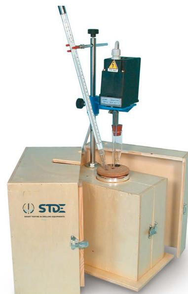
**AUTOCLAVE ÉLECTRIQUE POUR ESSAI D'EXPANSION DES CIMENTS**
