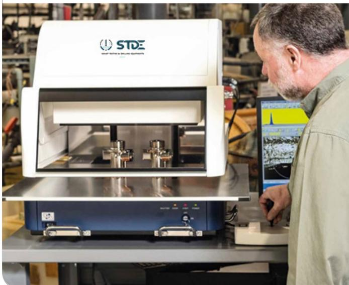
WDXRF pour analyse élémentaire des matériaux métalliques avec passeur d'échantillons
