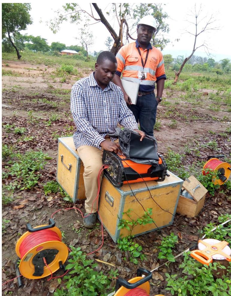
Les équipements que nous proposons sont particulièrement performants car ils permettent avant de commencer à forer, de séparer facilement les signaux émis par l'eau et par les roches (l'eau possède un faible coefficient de résistance qui sera repéré en bleu, et les cavités avec un facteur de résistance plus élevé en rouge), et d'explorer le sous-sol jusqu'à 250 mètres de profondeur en le visualisant sur un graphique en trois dimensions.
