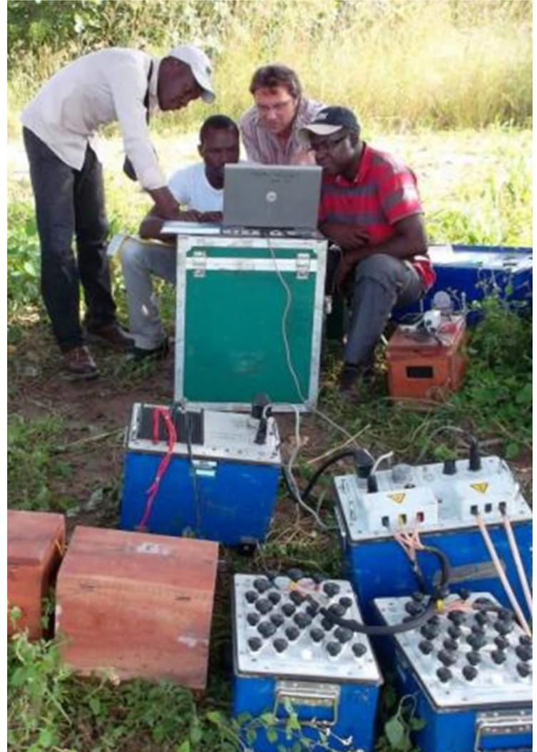
Contrairement aux mesures hydrogéologiques par résistivité ou conductivité électrique dont les résultats peuvent parfois être sujets à interprétation du fait que les paramètres mesurés ne concernent pas directement l'eau souterraine mais l'ensemble du milieu poreux, c'est-à-dire l'eau plus la roche, les mesures RMP des équipements que nous proposons sont directement liées aux caractéristiques des aquifères (teneur en eau, perméabilité, ...).
