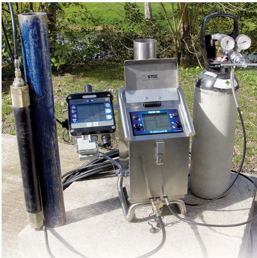
Le PREVO 100 est un Contrôleur Pression Volume (CPV) pour la mesure des caractéristiques géomécaniques des sols suivant le principe de l'expansion d'une cavité cylindrique.
