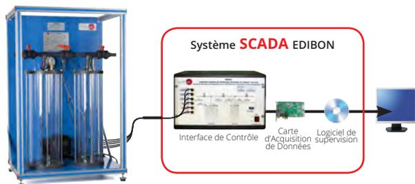
**TCMC** Équipement de Conductivité Thermique des Matériaux de Construction et d'Isolation, Contrôlé par Ordinateur (PC)
