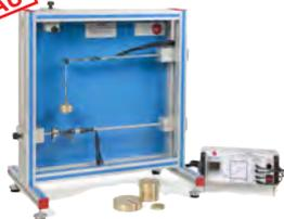
**MFGE** Équipement de Détermination du Facteur de Jauge de Jauges de Contrainte
