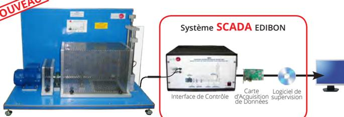
**EEICI** Équipement pour l'Essai des Impacts Charpy et Izod
