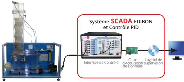
FPCC Équipement pour l'Étude de l'Écoulement dans Les Colonnes de Remplissage, Contrôlé par Ordinateur (PC)
