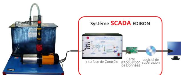
**HTRC** Turbine Expérimentale à Réaction, Contrôlée par Ordinateur (PC)
