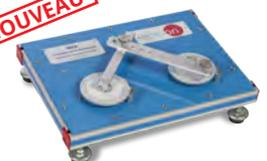
**MME** Mécanisme d'Arrêt Genève
