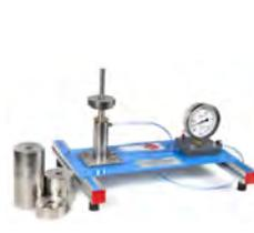
Appareil d'Etude de l'Étalonnage de Manomètres
