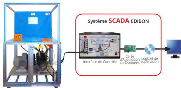
**TBMC12** Banc d'Essais pour Moteurs à Combustion Monocylindriques et à Deux Cylindres (11kW), Contrôlé par Ordinateur (PC)
