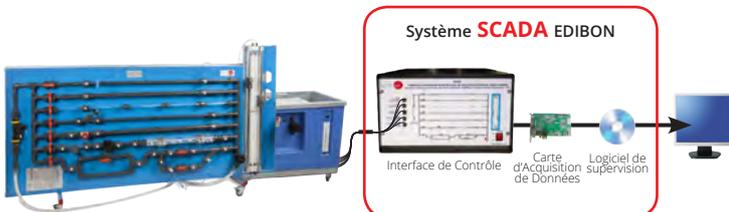
**AMTC** Équipement de Réseau de Conduites, avec Banc Hydraulique (FME00), Contrôlé par Ordinateur (PC)
