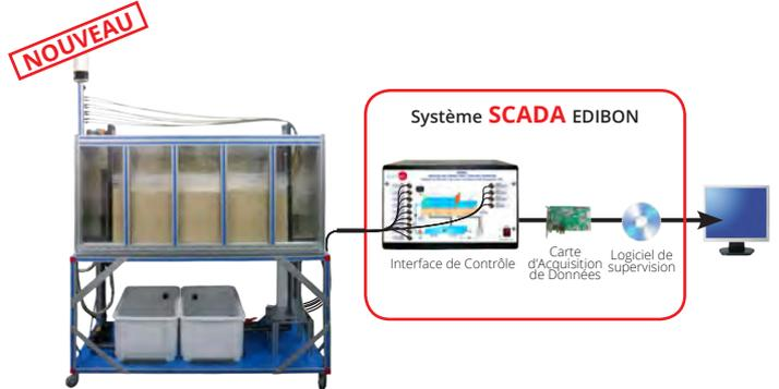
**PDDRC** Équipement de Processus d'Écoulement Stationnaires dans les Réservoirs, Contrôlé par Ordinateur (PC)
