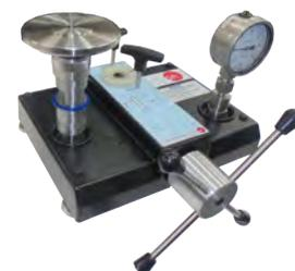
**TMCP** Équipement de Mesure et Étalonnage de Pression
