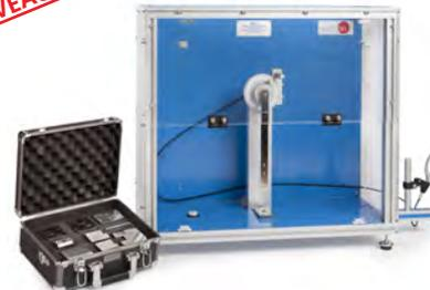
**EEDB** Équipement pour l'Essai de Dureté Brinell
