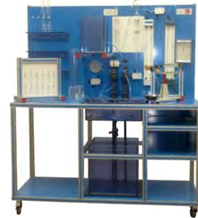
**LFA** Visualisation de Flux Laminaire et Unité d'Analyse
