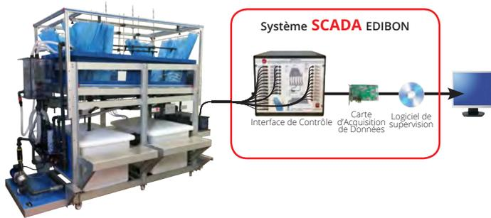
**PDFDC** Réservoir de Filtration et Drainage, Contrôlé par Ordinateur (PC)
