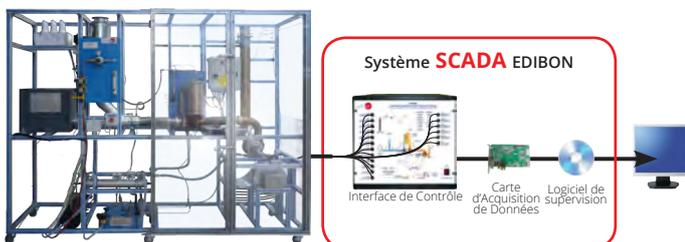
**TGDEPC** Turbine à Gaz à Deux Arbres/Moteur à Réaction, Contrôlée par Ordinateur (PC)
