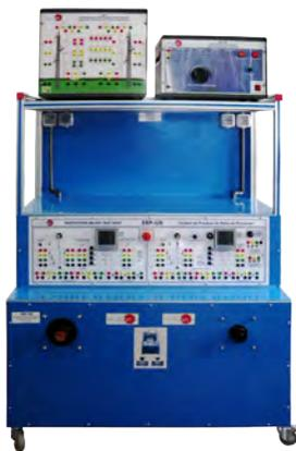
**ERP-UB** Équipement pour l'Essai de Relais de Protection
