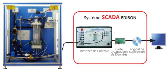
**HTVC** Turbine à Vapeur avec Source d'Énergie Solaire, Contrôlée par Ordinateur (PC)
