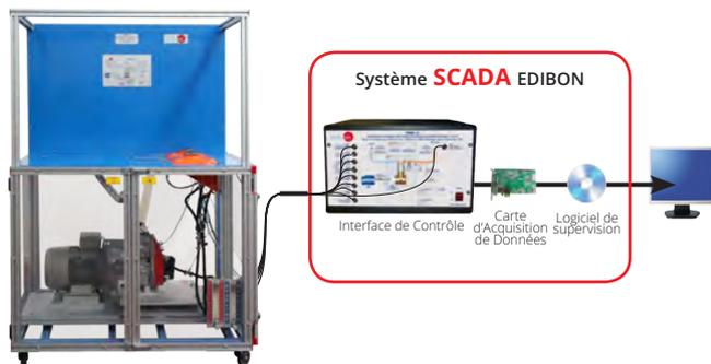
**TBMC8** Banc d'Essais pour Moteurs à Combustion Monocylindriques (7,5kW), Contrôlé par Ordinateur (PC)
