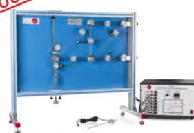
**MFCS3** Appareil d'Étude de la Déformation dans Treillis
