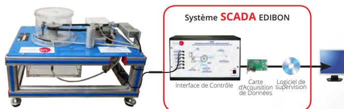
**TFAC** Turbine à Écoulement Axial, Contrôlée par Ordinateur (PC)
