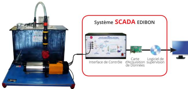
**TFAC** Turbine à Écoulement Axial, Contrôlée par Ordinateur (PC)
