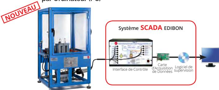
**TBMC75** Banc d'Essais pour Moteurs à Combustion (Quatre Cylindres) (75kW), Contrôlé par Ordinateur (PC)
