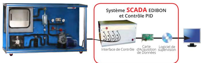
**THALAC/1** Équipement de Contrôle de Réfrigération, avec plusieurs Compresseurs, Contrôlé par Ordinateur (PC)
