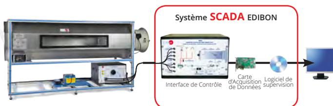
**AEL-WPT** Application d'Énergie Éolienne avec Générateur Synchrone à Aimants Permanents
