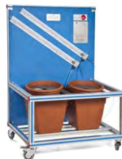
**PPD** Perméamètre de Drainage
