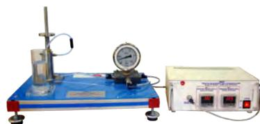
**SCSP** Système de Calibration de Capteurs de Pression
