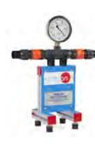
Système de Mesure de Dépression (vacuomètre)
