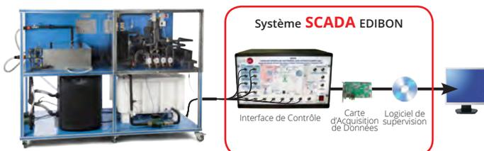
**EG6C** Équipement d'Énergie Géothermique (haute enthalpie), Contrôlé par Ordinateur (PC)
